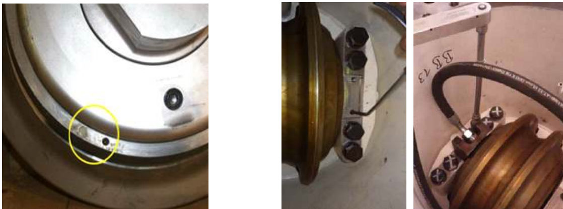
그림 22, DCRM 시스템의 디스크커터에 삽입된 자석(좌) 및 온도 센서(우)
