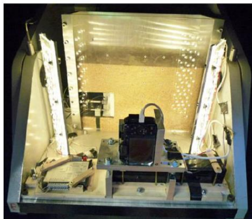
그림. 19: 원심분리 실험장치의 Model assembly [Idinger et al., 2011]
