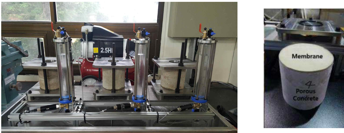
[그림 4.10] 뿔칠 멤브레인의 수밀성 평가에 사용된 투수시험기 및 공시체
