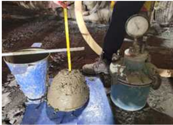
[그림 3.6] 현장 품질 시험(슬럼프 및 공기량)
