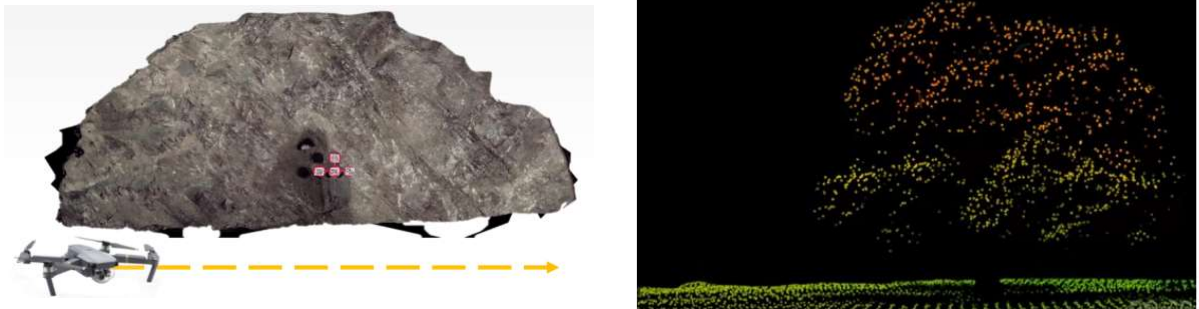
[그림 3.3] 드론을 활용한 터널 막장면 촬영 및 획득 데이터 예시
