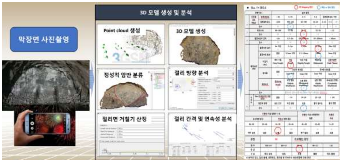
[그림 3.2] 디지털매핑에 의한 암반등급 평가 및 분류 (나상민, 2023)
