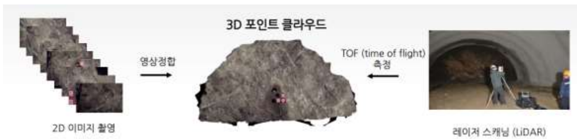
[그림 3.2] 암반면에 대한 3D포인트 클라우드 획득 과정
