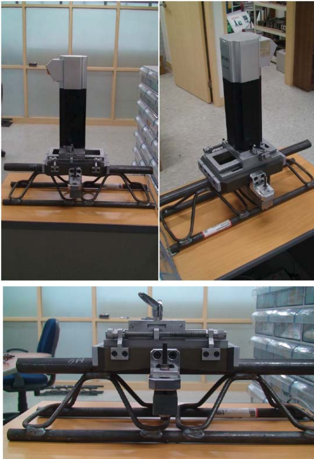
[그림 2.7] 격자지보재에 대한 계장화압입시험
